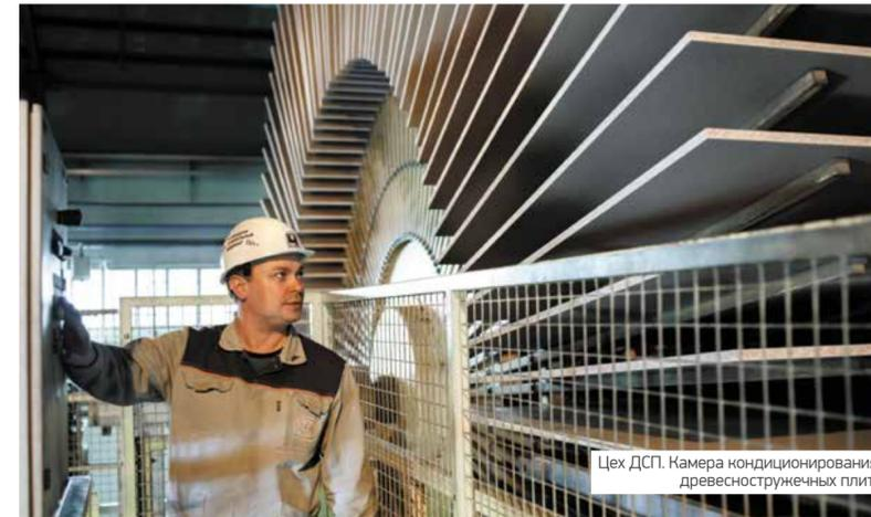
Цех ДСП. Камера кондиционирования древесностружечных плит.
